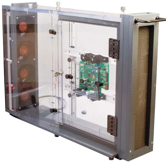
Abbildung 3 – Tischwindtunnel für die thermische Analyse
