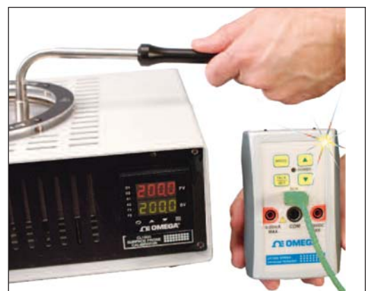
Abb. 4 UV1000 bei der Ansage der Temperatur, gemessen mit einem OMEGA® CL1600-Kalibrator für Oberflächentemperaturfühler
