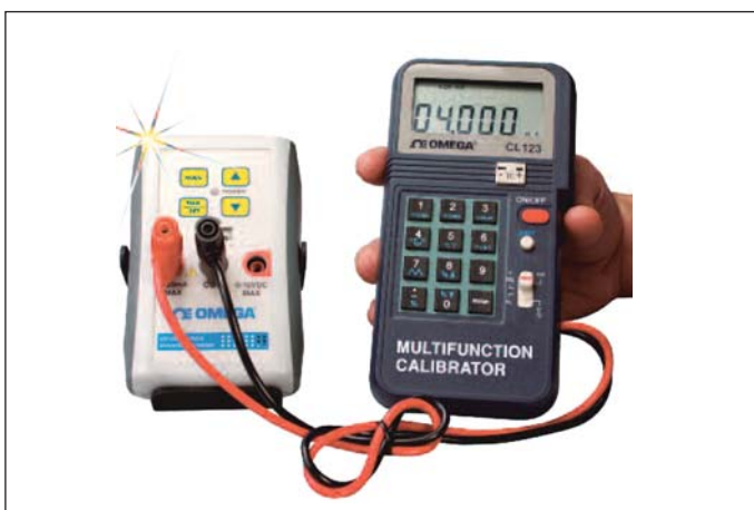
Abb. 3 UV1000 bei der Ansage des Stroms, gemessen mit einem OMEGA® CL123-Multifunktionskalibrator
