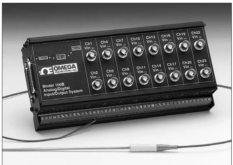
iNET-100B mit angeschlossenem Omega Mantelthermoelement. Das Thermoelement ist nicht im Lieferumfang enthalten.
