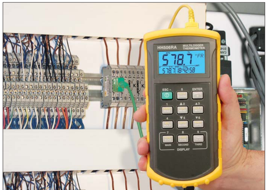
Abbildung mit RECK1-10 Kabel und HH506RA Datenlogger/Thermometer mit RS232-Schnittstelle
