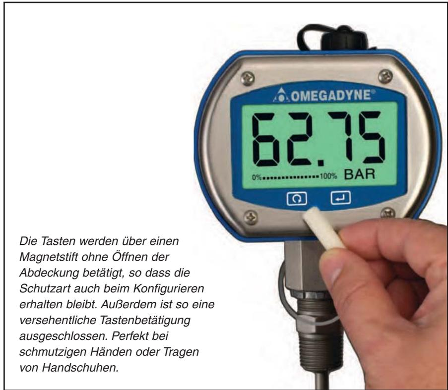
*Die Tasten werden über einen Magnetstift ohne Öffnen der Abdeckung betätigt, so dass die Schutzart auch beim Konfigurieren erhalten bleibt. Außerdem ist so eine versehentliche Tastenbetätigung ausgeschlossen. Perfekt bei schmutzigen Händen oder Tragen von Handschuhen.*
