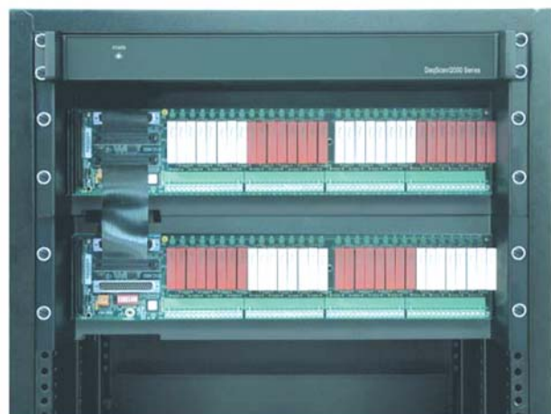
Das System mit 64 diskreten, galvanisch getrennten Ein- und Ausgängen besteht aus einem OMB-DAQSCAN-2005 und OMB-DBK210-Karten mit Rackmontagesatz.
