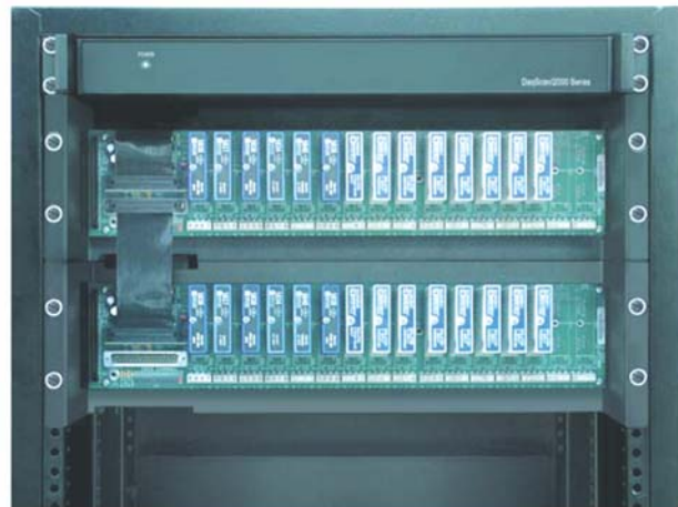
Das 24-kanalige System mit galvanischer Trennung besteht aus einem OMB-DAQSCAN-2005 plus zwei OMB-DBK207/CJC-Karten. Das System tastet alle Kanäle mit 200 kHz ab. Alle Eingänge sind bis 500 V galvanisch getrennt.
