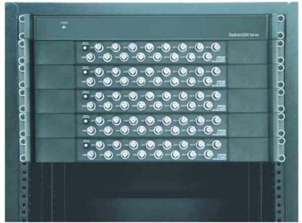
Das 80-kanalige Hochgeschwindigkeits-Messsystem besteht aus einem OMB-DAQSCAN-2005 mit fünf OMB-DBK85-Modulen mit je 16-Spannungseingängen. Alle Kanäle werden mit der maximalen Rate von 5 \mu s/Kanal gemessen.
