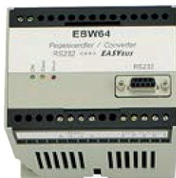
**Max. zulässige Sensormodulanzahl:** 64 (abhängig von den verwendeten Sensormodulen)
