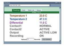
Ein Java-Applet zeichnet die Messwertegrafik in Echtzeit über das LAN oder Internet auf. Damit erspart der iSD den Zeit- und Kostenaufwand für die Anschaffung und Einarbeitung in separate Software zur Messwerterfassung und Aufzeichnung.
