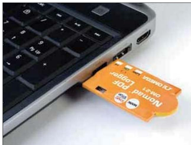
*Zur einfachen Programmierung und Auswertung der gespeicherten Daten wird der OM-21 direkt in den USB-Port des Computers eingesteckt.*
