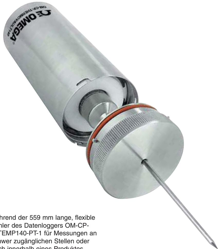
während der 559 mm lange, flexible Fühler des Datenloggers **OM-CP-HITEMP140-PT-1** für Messungen an schwer zugänglichen Stellen oder auch innerhalb eines Produktes geeignet ist.
