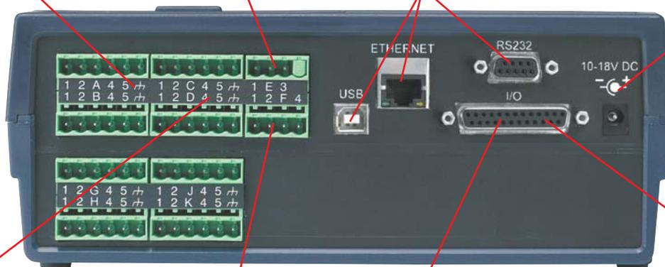
Einfach einzusetzender, abnehmbarer Klemmenblock
