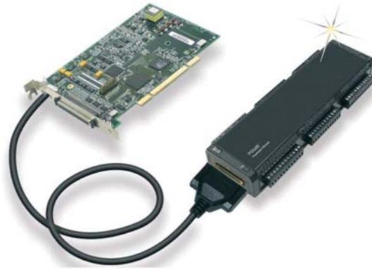
OMB-DAQBOARD-3000 mit **OMB-CA-266**-Kabel und angeschlossenem **OMB-PDQ30**-Erweiterungsmodul.
