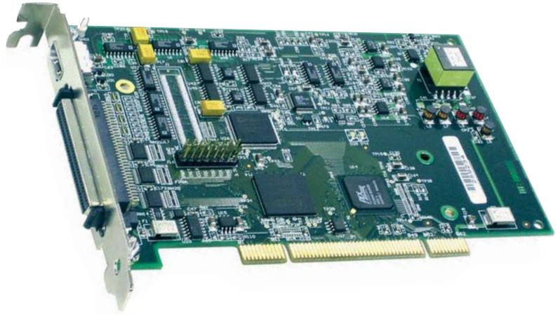
*OMB-DAQBOARD-3000 mit 1-MHz-Messrate und synchronisierbaren I/Os, erweiterbar und mit umfangreicher Software-Unterstützung.*
