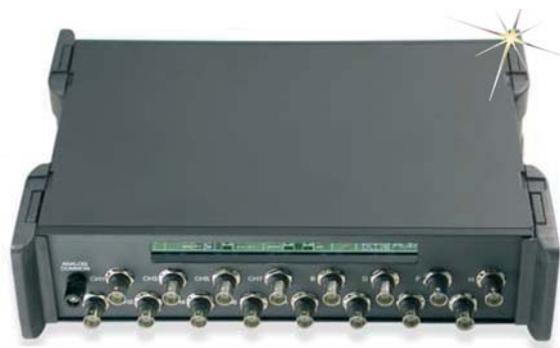
**OMB-DBK215** Das OMB-DBK215-Modul verfügt über 16 BNC-Buchsen und (intern) einen Schraubklemmenblock.
