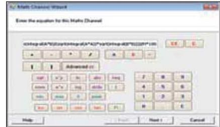
Die Oszilloskope der Serie OMSP-2000 bieten eine Reihe von Rechenfunktionen zum Verarbeiten und Kombinieren von Kanälen. Die Funktionen können auch für Referenzwellenformen genutzt werden. Verwenden Sie die integrierte Liste für einfache Funktionen wie die Addition oder Vorzeichenumkehr oder öffnen Sie den Gleichungseditor, um komplexe Funktionen einschließlich von Trigonometrie, Exponentialfunktionen, Logarithmen, Statistiken, Integralen und Ableitungen zu erstellen.
