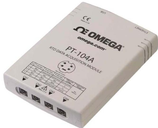
Der PT-104 ist ein 4-kanaliges Datenerfassungsmodul zur hochauflösenden Messung von Temperaturen mit Pt100- und Pt1000-Widerstandsfühlern. Daneben misst es auch Widerstand (375-Ohm- und 10-kOhm-Bereiche) und Spannung (115-mV- und 2,5-V-Bereiche). Bei der Temperatur- und Widerstandsmessung verwendet das Gerät eine 4-Leiterschaltung. Bei Spannungsmessungen kann jeder Eingangsanschluss als differenzieller Eingang mit Masse oder als zwei einseitig geerdete Eingänge verwendet werden.
