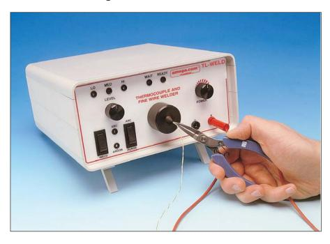
Der Drahtdurchmesser für die Thermoelement-Typen C, D, R, S und B ist maximal 0,25 mm.
