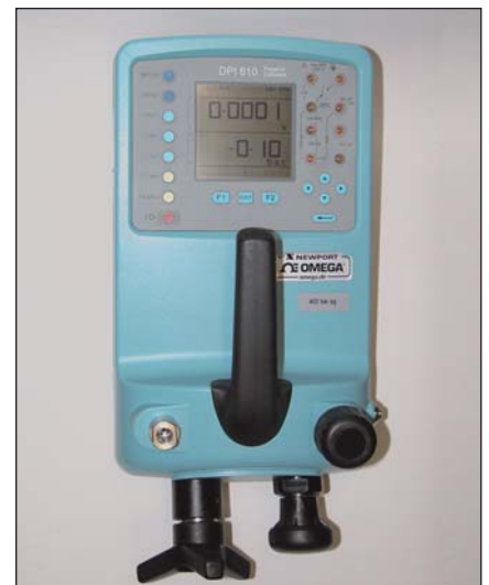
Hydraulischer Kalibrator Modell DPI610HC-400bar
