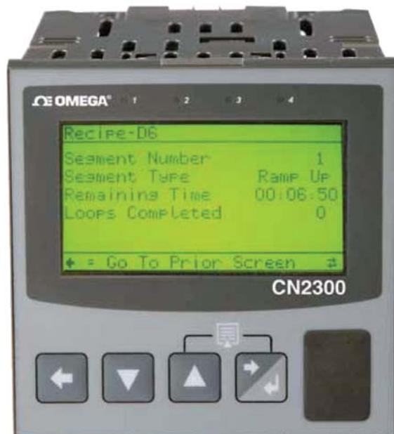
Einfache Programmierung der Rampenfunktion über das grafikbasierte Menü.
