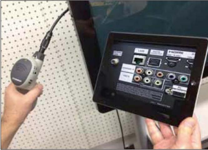
Mit dem iBorescope lassen sich die Anschlüsse auf der Rückseite von Baugruppenträgern oder an der Wand angebrachten Geräten einfach erkennen.
