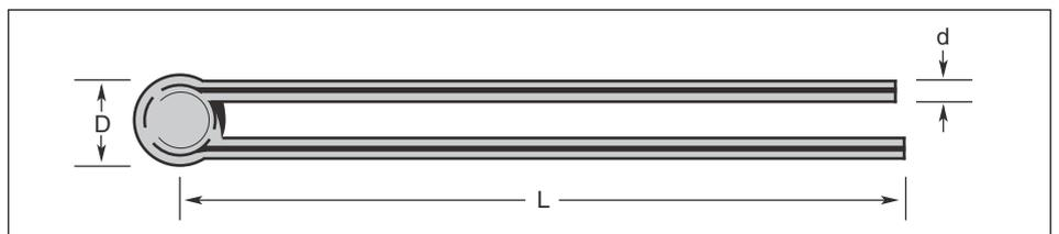
Alle Thermoelemente haben eine perlenförmige Spitze, deren Durchmesser D ungefähr das 2,5-fache des Drahtdurchmessers d beträgt wie in der Abbildung oben dargestellt. Zur einfacheren Unterscheidung sind die Minus-Leitungen etwas kürzer als die Plus-Leitungen.
