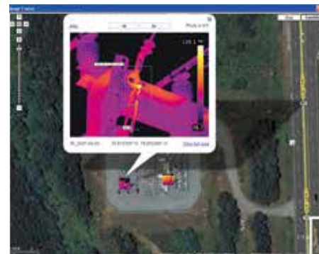
FLIR-Kunden, in deren Kameras eine GPS-Funktion integriert ist, bietet FLIR Reporter einen automatischen Link zu Google™ Maps für Bilder mit GPS-Koordinaten.
