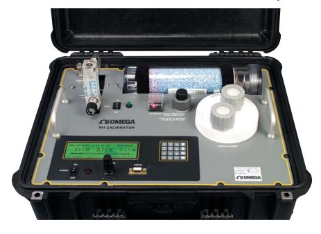
Für die Regelung der Feuchte nutzt der RHCL-2 einen besonderen Ansatz: Das System verfügt über zwei volumetrische Proportionalventile für "trocken" und "feucht", die unabhängig voneinander über ihren gesamten Stellbereich geregelt werden können, um jede gewünschte Feuchte schnell zu generieren. Außerdem überwacht der RHCL-2 die Feuchte kontinuierlich über den in der Messkammer integrierten Spiegel, so dass eventuelle Feuchteänderungen schnell und stabil ausgeregelt werden können.
