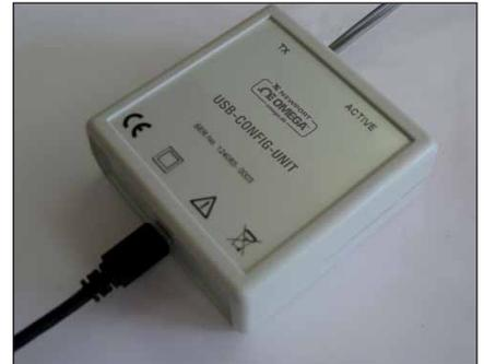
USB-CONFIG-UNIT Programmierereinheit zur Konfiguration über USB
