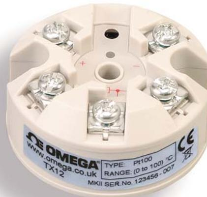
Der neue TX12-Transmitter für die Kopfmontage setzt das Signal eines angeschlossenen Pt100-Temperaturfühlers in ein linearisiertes 4-20-mA-Signal um.
